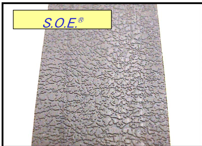
学振摩耗(10,000回)試験後の表面の写真
